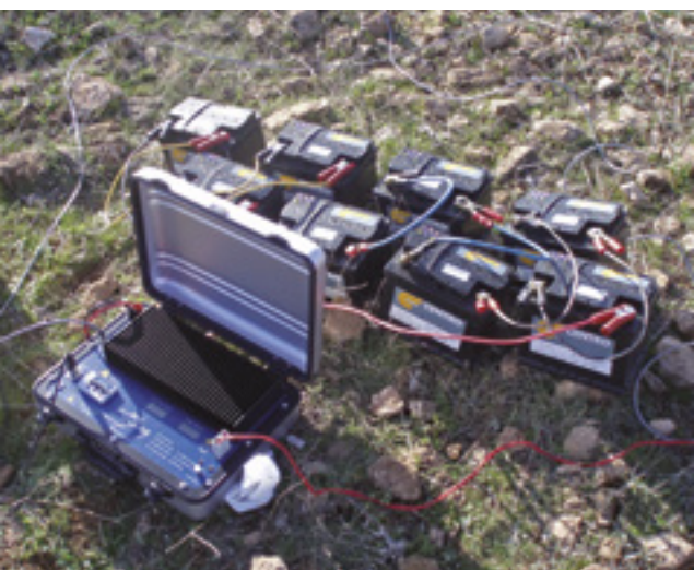
Equipo Trasmisor SEDT (TerraTx-50).
